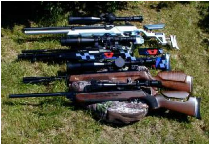
*Field-Target-Luftgewehre und Zielfernrohre. Von hinten nach vorn: Anschütz 2020 HP mit Tasco Custom 10-40x52, Air Arms Pro Traget mit getuntem Leupold 10-40x52, Air Arms TX 200 SR mit Tasco Custom 10-50x52 und Weihrauch HW 98 mit Tasco Varmint 6-24x42. Die großen „Schwungräder“ sind seitliche Parallaxenausgleichsverstellungen, die eine schnelle Entfernungsmessungen ermöglichen. Das Tasco Varmint hat einen etwas unbequemen Parallaxenausgleichsring am Objektiv*
